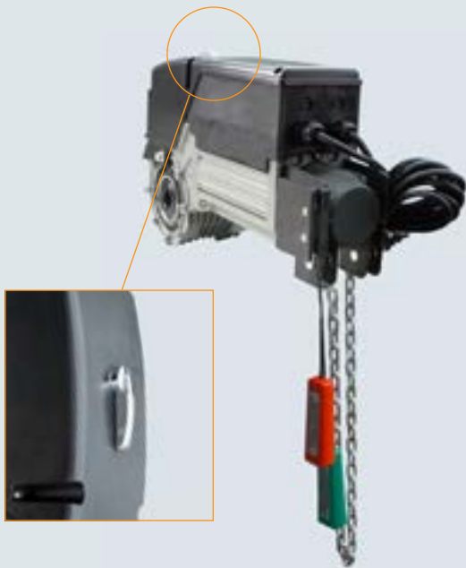
标配维修离合及手动倒链，手动倒链在操作时需配合红绿离合拉绳进行使用
