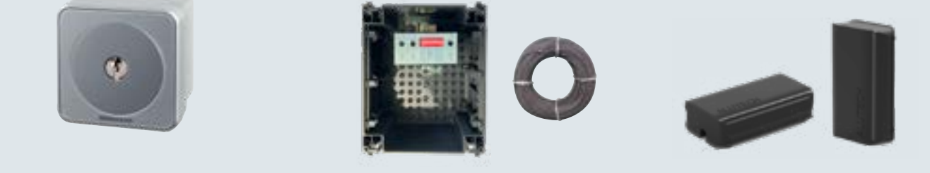
钥匙开关, 标配 3 把钥匙 面装式 STUP 50 脉冲或可选开 / 关功能 开关尺寸: 80 × 80 × 63 mm (W × H × D); 防护等级: IP 54 嵌入式 STAP 30 尺寸: 80 × 80 mm (W × H); 适用于一体式 WA 300 电机以及配 360 控制箱的 WA 300 电机 适用于 A 450, 545, 560 控制箱 地磁感应器 DI 2 - MD 带独立箱体 适用于双线圈 感应器带两个常开触点 可以设置为脉冲或常闭触点 可实现方向识别 箱体尺寸: 202 × 164 × 130 mm (W × H × D) 含线圈铜线 80 m / 120 m 每卷 适用于配 360 控制箱的 WA 300 电机 适用于 A 450, 545, 560 控制箱 单向式光眼 LM-L 独立的发射端与接收端 每次开关门之前，系统都会对光眼进行检测 通过多芯线缆连接 最远适用距离为 12.0 m 带安装支架的尺寸: 55 × 90 × 27 mm (W × H × D) 防护等级: IP 54 适用于 A 450 控制箱
