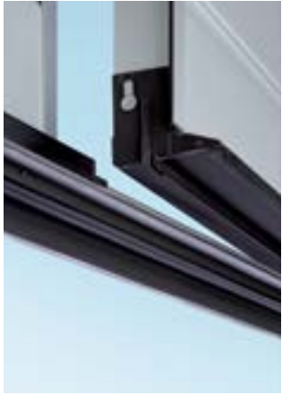
良好的保温性 不锈钢底槛与地面之间，以及门中门门扇与不锈钢底槛之间均配有柔软的密封条，可以弥补现场地面的轻微不平，确保整门良好的密封性和保温性。
