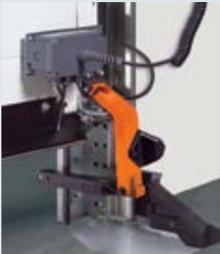
无接触的前置式光眼，对通行人员和货物进行全方位的保护。
