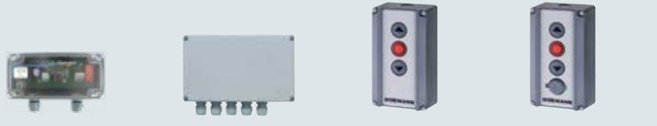
单通道接收器 HER 1 BS 带有干触点的继电器输出，不含连接线 适用于一体式 WA 300 电机以及配 360 控制箱的 WA 300 电机 适用于 A 450, 545, 560 控制箱 4 通道接收器 HER 4 BS 带 4 个继电器输出端子 适用于一体式 WA 300 电机以及配 360 控制箱的 WA 300 电机 适用于 A 450, 545, 560 控制箱 按钮开关 DTH R 独立的开/停/关按键 防护等级: IP 65 尺寸: 90 × 160 × 55 mm (W × H × D) 适用于一体式 WA 300 电机以及配 360 控制箱的 WA 300 电机 适用于 A 450, 545, 560 控制箱 按钮开关 DTH RM 独立的开/停/关按键 带迷你锁: 用于锁闭开关功能，防止无关人员开启大门（配 2 把钥匙） 防护等级: IP 65 尺寸: 90 × 160 × 55 mm (W × H × D) 适用于一体式 WA 300 电机以及配 360 控制箱的 WA 300 电机 适用于 A 450, 545, 560 控制箱
