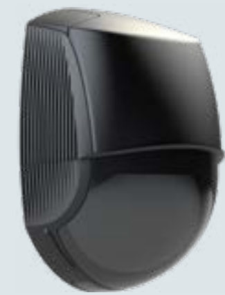
3D 激光扫描雷达 快速准确的实现自动开门，以及可靠的保护功能。 最大安装高度为 6 m。 壳体防护等级：IP 65 适用于 545, 560 控制箱
