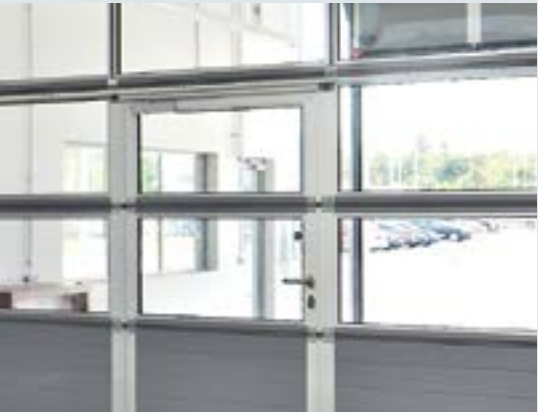
门框和五金件为镀锌表面，无其它涂层。复合视窗框标准为黑色。门板加强筋和侧堵型材标准为RAL 9002 灰白色。当配有无门槛门中门时，门中门的侧部铝型材均为铝本色，表面经阳极氧化处理，E6 / C0。
