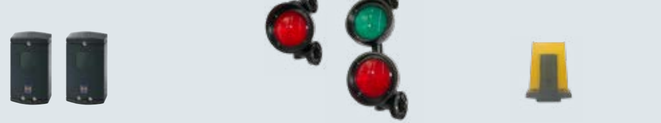
单向式光眼 EL 51 独立的发射端与接收端 每次开关门之前，系统都会对光眼进行检测 通过系统电缆连接 最远适用距离为 8.0 m 带安装支架的尺寸: 60 × 165 × 43 mm (W × H × D) 防护等级: IP 65 适用于一体式 WA 300 电机以及配 360 控制箱的 WA 300 电机 适用于 545, 560 控制箱 红/绿信号灯 钢质外壳，含安装支架 防护等级 IP 65 需配多功能线路板 适用于配 360 控制箱的 WA 300 电机 适用于 A 450, 545, 560 控制箱 黄色警示灯 黄色，塑料外壳 防护等级 IP 54 需配多功能线路板 适用于配 360 控制箱的 WA 300 电机 适用于 A 450, 545, 560 控制箱
