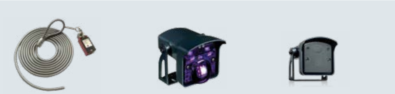
拉绳开关 可以水平或垂直安装，铸铝壳体，防护等级 IP 65， 拉绳长度为 4 m C 型红外雷达 通过雷达感应物体的移动，通过红外感应物体的存在，从而快速准确的实现自动开门，可靠的保护功能。 最大安装高度为 6 m。 在潮湿环境以及室外环境，仅雷达功能起作用。通行车辆行驶速度需控制在 20 km/h 以内。 壳体防护等级: IP 65 适用于配 360 控制箱的 WA 300 电机 适用于 A 450, 545, 560 控制箱 F 型微波雷达 通过微波感应物体的移动，从而快速准确的实现自动开门，最大安装高度为 7 m。 通行车辆行驶速度需控制在 20 km/h 以内。 壳体防护等级: IP 65 适用于配 360 控制箱的 WA 300 电机 适用于 A 450, 545, 560 控制箱
